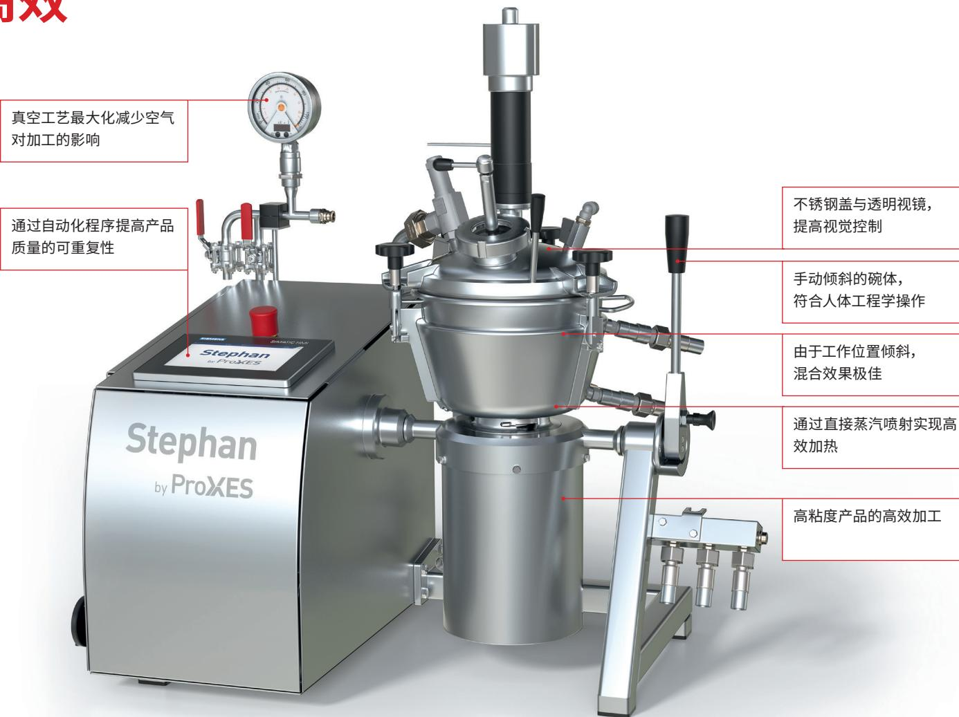
随着UMX 5S的出现，我们进一步扩展了我们的基本UMX5型号的应用范围。由于其采用蒸汽直喷，可以快速加热产品最高至110°C，UMX 5S也可用于生产再制奶酪。其效率、速度和灵活性使UMX 5S成为一个完美的全方位实验室和研发应用设备。
