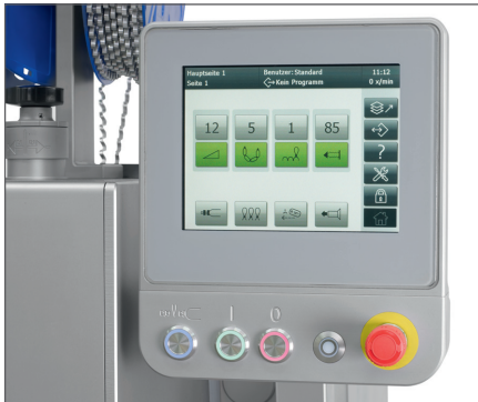
La commande des doubles clippeuses automatiques a lieu sur un écran tactile.
