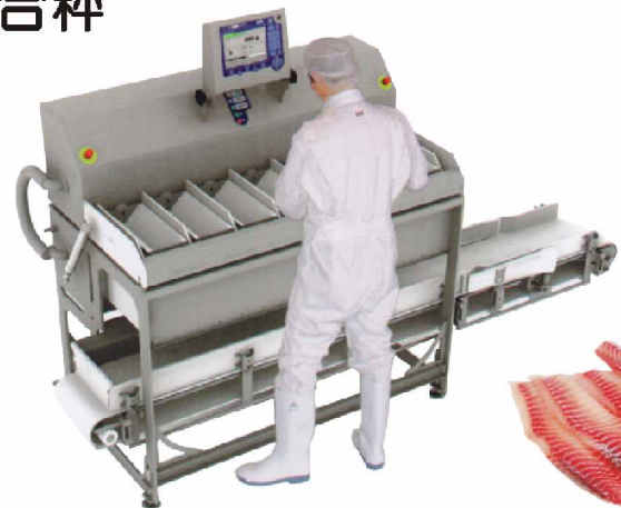
● 每片不同重量原料，秤重後自動配對成 每堆固定重量，省人力，提高精準度。
