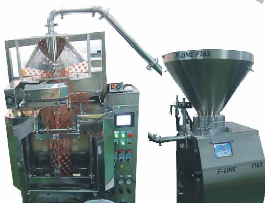
(A) 搭配給袋式包裝機 (各式袋子) 自動取袋→開袋→充填→封口
