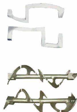
T型或獨特Z字型攪拌臂混合搓揉效果最好
