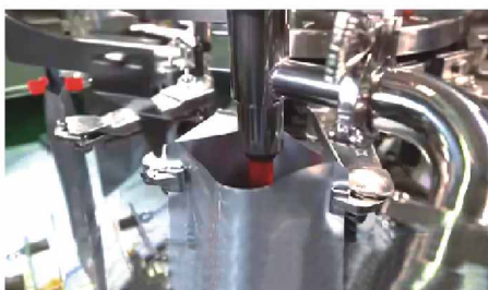
(A) 搭配給袋式包裝機 (各式袋子) 自動取袋→開袋→充填→封口
