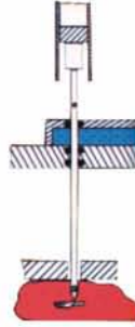
針碰到骨頭，汁液 停止注射，確保骨頭 周圍沒有多餘之汁液
