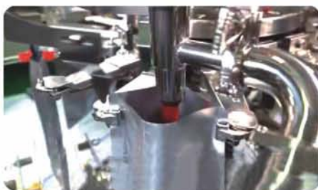
(B) 搭配給袋式包裝機(各式袋子) 自動取袋→開袋→充填→封口
